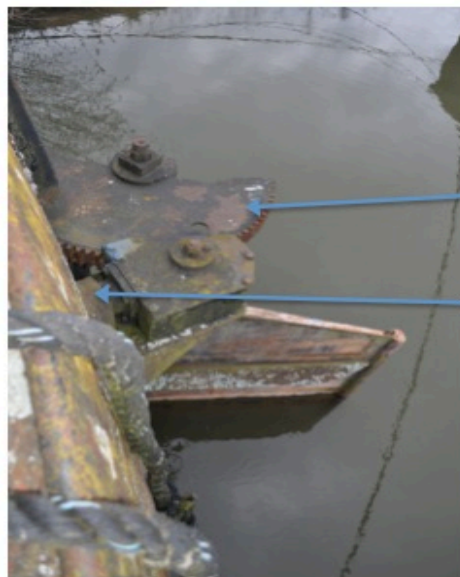
n° 5 - Section du gouvernail, mécanisme d'entrainement du gouvernail
