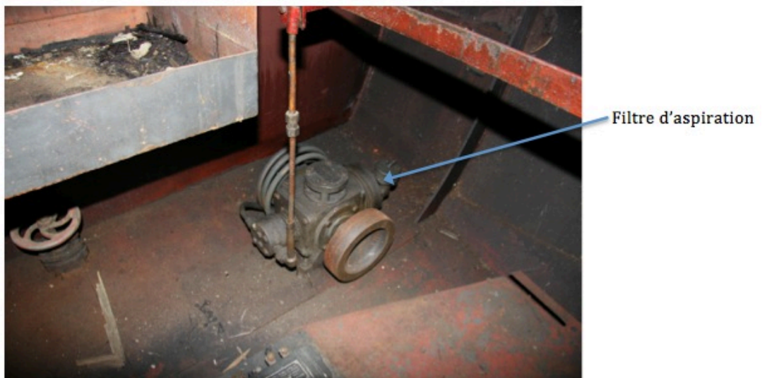
n°6 - Compresseur ERVOR à deux étages, basse et haute pression pour remplir la bouteille d'air pour le lancement du moteur
