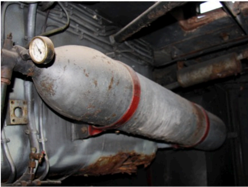
n°7 - Bouteille servant à stocker l'air pour le lancement du moteur (40 bars)
